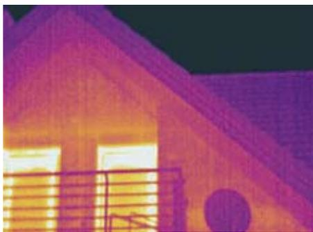
На фотографии дома, построенного по системе YTONG отчетливо видно, что поверхность стены однородная – через нее не теряется тепло. Даже такие трудные места, как перемычки, теплые и хорошо изолированы. Разница температур между отдельными фрагментами стен совсем незначительная.
