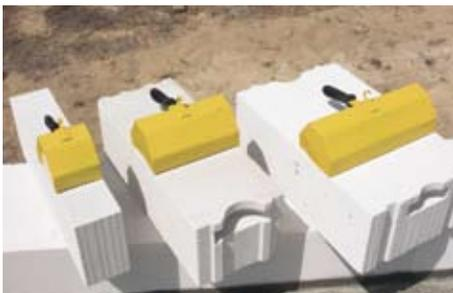
**Мастерки** – при их помощи можно точно нанести раствор, обеспечивая его толщину 1-3 мм. Ширина мастерка подогнана к ширине блоков YTONG, благодаря чему раствор раскладывается равномерно по всей поверхности блока (он не капает по бокам, а положенная стена – чистая).
