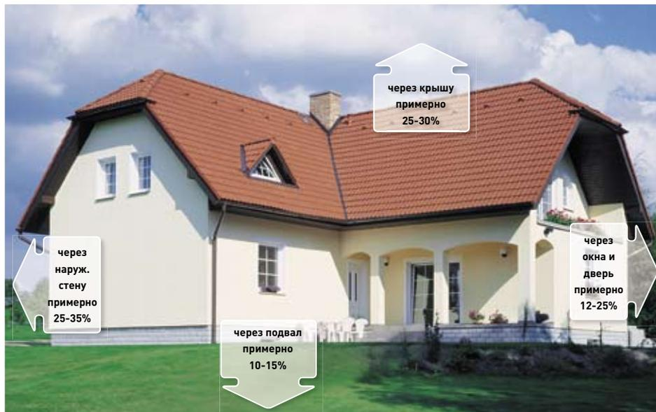
Больше всего тепла теряется через наружную стену – до 35%. Это можно предотвратить, проектируя дома с наружными стенами с самым низким коэффициентом проникания тепла  $U$ , а также с большой тепловой емкостью. Благодаря этому, стены дома зимой аккумулируют тепло, а летом удерживают приятный холод.
