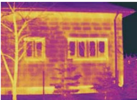
На термовизионной фотографии – дом, построенный по двухрядной системе – с дополнительным утеплением на традиционном растворе. Четко видны все горизонтальные и вертикальные швы, через которые теряется тепло.
