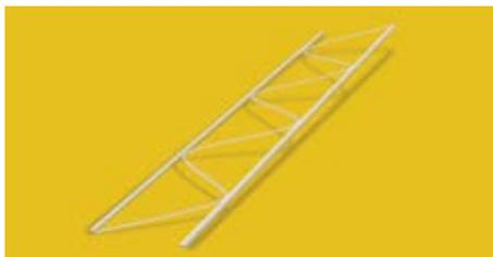
В первую очередь мы обозначим на поверхности блоков планируемую длину оконных проемов. Потом мы отрежем арматуру на необходимую длину. Следует помнить, чтобы размер арматуры увеличить, по крайней мере, на 0,5 м за пределы проемов.
